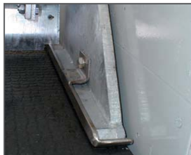
breite und hochgezogene Seitenkufen angeschraubt
