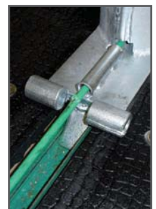
breite Auflage für Mittelbock, Rundeisen angeschweißt
