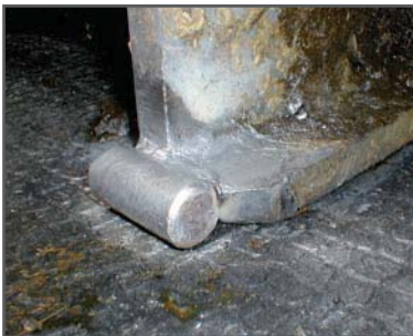
Seitenkufen mit Rundeisen und breiter Auflage
