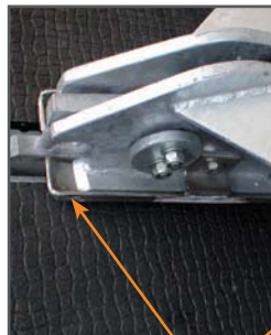
breite Auflage für Mittelbock, kufenförmig hochgezogen
