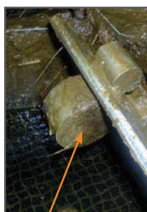
Steuerkufe an Haupträumklappe
