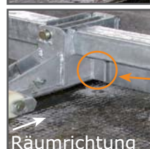
Steuerkufe an Haupträumklappe
