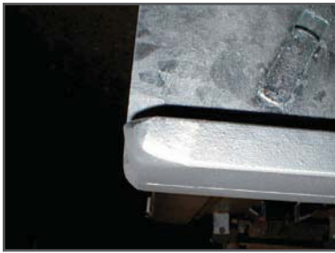
Auflagefläche der Seitenkufe abgerundet
